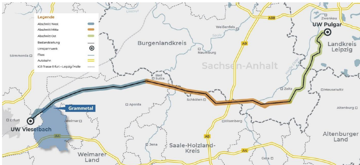
Abbildung 3: Trassenverlauf des Ersatzneubaus der 380-kV-Freileitung zwischen Pulgar-Vieselbach
